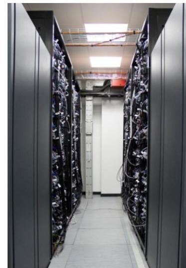
1 стойка = 256 узлов: Intel Xeon (14с) + NVIDIA K40= 515 Tflap/s
